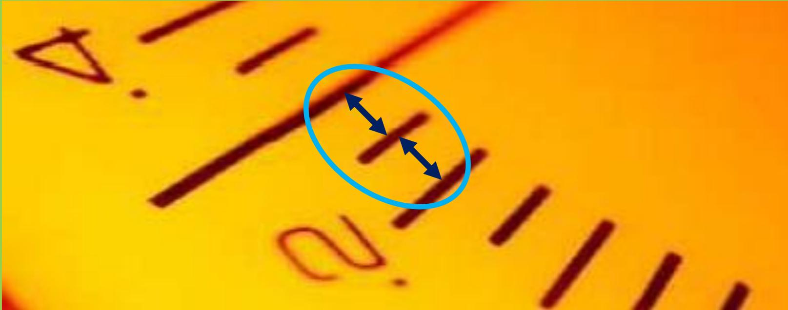
**Regla simple:** para realizar una medición, no se debe tratar de leer  $\frac{1}{2}$  ó  $\frac{1}{4}$  de una división en un instrumento analógico, ya que la precisión del instrumento usualmente no es mejor que la división mínima.
